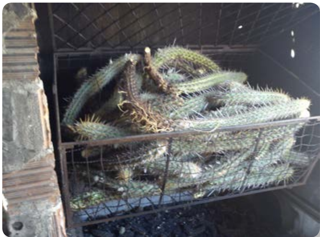
Forno (metálico, giratório) a gás butano, abastecido para a queima dos espinhos. Fazenda Santo Estevão – Pedro Avelino/ RN, 2012.
